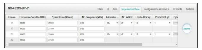
I canali 1.1 e 1.2 condividono l'alimentazione tra loro tramite LNB-1. I canali 2.1 e 2.2 condividono l'alimentazione tramite LNB-2.
